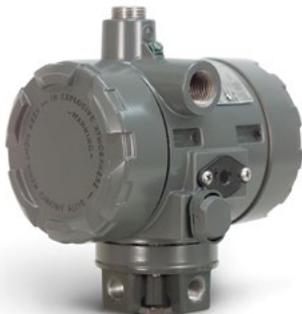
**Elektro-pneumatische (I/P) Messwandler** wandeln ein elektronisches Signal in ein pneumatisches Signal um. Sie werden hauptsächlich in Regelkreisen eingesetzt, bei denen ein elektronisches Steuersignal von einer speicherprogrammierbaren Steuerung oder einem verteilten Steuerungssystem in ein nutzbares pneumatisches Signal für den Betrieb eines Regelventils umgewandelt werden muss. ► [i2P-100](#) | [646](#) | [846](#)
