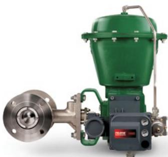
**Exzentrische Kükenhähne** kombinieren die Robustheit eines Durchgangsventils mit der Effizienz eines Drehventils, deshalb werden sie auch als „Drehventile in Durchgangsausführung“ bezeichnet. Sie haben ein kegelförmiges, strömungsbegrenzendes Stellelement, das beim Drehen einer exzentrischen Bahn folgt. ► [V500](#) | [CV500](#)
