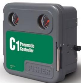
I **controllori pneumatici** sono dispositivi meccanici progettati per misurare la temperatura o la pressione e per trasmettere un segnale di correzione dell'aria all'elemento di controllo finale. Come elementi di rilevamento si utilizzano tubi di Bourdon, soffietti, sensori di temperatura o dislocatori. L'alimentazione e l'uscita di un controllore pneumatico sono costituite da aria compressa o gas naturale. ► [C1](#) | [4194](#) | [4195K](#) | [4196](#) | [4660](#)
