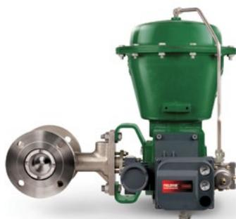
Le **valvole a maschio eccentriche** combinano la robustezza delle valvole a globo con l'efficienza di una valvola rotativa, per cui sono anche chiamate valvole a globo rotative. Queste valvole hanno un elemento limitatore di flusso a maschio che segue un percorso eccentrico durante la rotazione. ► [V500](#) | [CV500](#)
