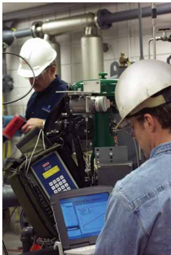
Grâce aux tests de diagnostic, la durée de fonctionnement de la vanne est allongée
