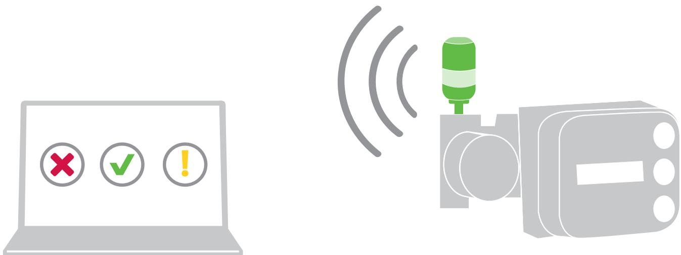
L'**accesso wireless** alla diagnostica è possibile in qualsiasi posizione con l'adattatore Smart Wireless THUM, che può essere utilizzato su qualsiasi posizionatore digitale di valvole con protocollo di comunicazione HART® e che consente la trasmissione wireless delle informazioni di misura e diagnostiche.
