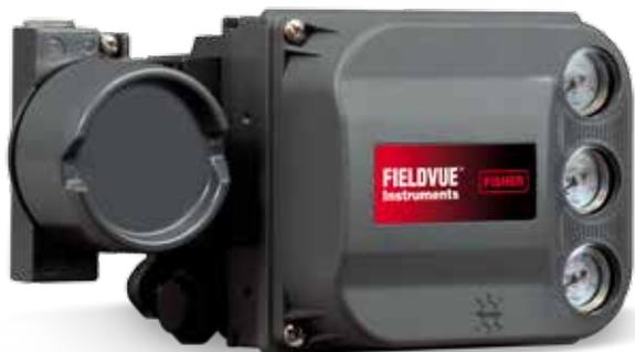
Il posizionatore per valvole digitale FIELDVUE DVC6200 è uno strumento di comunicazione HART che converte un segnale di comando a 2 fili da 4-20 mA in un'uscita pneumatica a un attuatore. Consente di ottenere con facilità comunicazioni digitali in installazioni analogiche esistenti.
