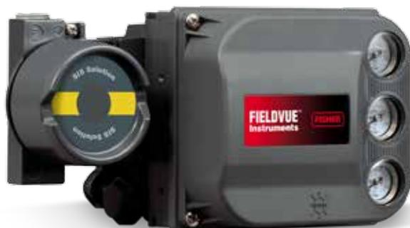
Il posizionatore digitale per valvole FIELDVUE DVC6200 è uno strumento di comunicazione HART utilizzato in applicazioni di valvole come arresto di emergenza, scarico di emergenza, sfiato di emergenza e isolamento di emergenza. Lo strumento DVC6200 SIS monitora la salute e controlla la funzione di arresto di emergenza della valvola.
