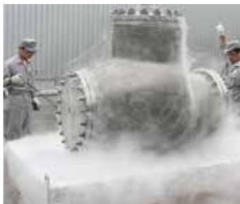
И при экстремальных технологических температурах, и при экстремальных погодных условиях регулирующие клапаны должны работать в соответствии с заявленными характеристиками. Регулирующие клапаны Fisher для производств СПГ обычно испытываются при криогенных температурах  $-196^{\circ}\text{C}$  ( $-321^{\circ}\text{F}$ ) на многочисленных объектах Fisher по всему миру.
