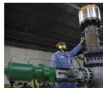
На своем предприятии площадью  $4738\text{ м}^2$  ( $51000\text{ фут}^2$ ) с уникальной акустической камерой площадью  $2415\text{ м}^2$  ( $26000\text{ фут}^2$ ) компания Emerson может проводить количественный анализ шума от клапанов, трубопровода и воздушников. Это дает возможность глубокого изучения для высокоточного прогнозирования уровня шума и помогает вам обеспечить соответствие нормативным требованиям.
