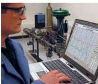
Узлы регулирующих клапанов Fisher подвергаются эксплуатационным динамическим испытаниям для оценки их способности снижать вариабельность технологического процесса. Эти испытания воспроизводят работу регулирующих клапанов на вашем заводе.
