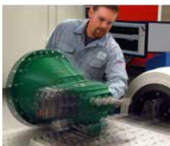
Регулирующие клапаны Fisher разработаны и испытаны на устойчивость в задачах с вибрацией. Они подвергаются дополнительным испытаниям в течение миллионов циклов на резонансной частоте (по самому неблагоприятному сценарию), чтобы повысить их эффективность на вашем предприятии.
