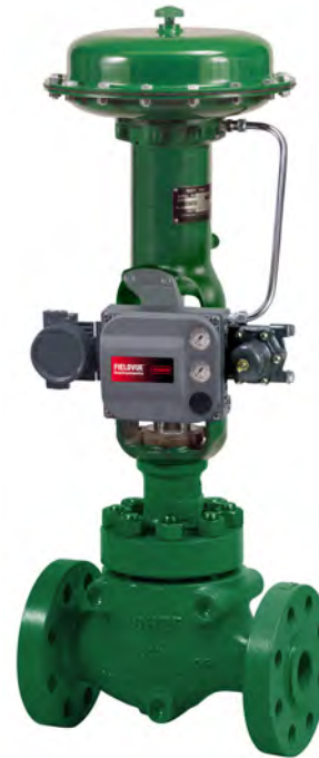
VENTIL FISHER HP S OVLÁDACÍM ZAŘÍZENÍM 667 A DIGITÁLNÍ ŘÍDICÍ JEDNOTKOU VENTILU FIELDVUE™ DVC6200
