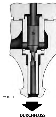
Abbildung 16. Fisher HPAS-Innengarnitur mit Micro-Flat Ventilkegel
