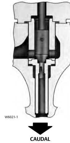
Figura 16. Internos Fisher HPAS con obturador de válvula Micro-Flat
