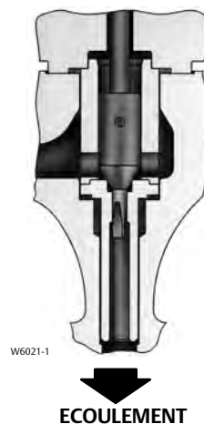
Figure 17. Eléments internes de vanne HPT Fisher avec cage Whisper Trim III niveau A1 (disponibles également en types HPD [2 à 6 NPS] et HPS [2 et 3 NPS])
