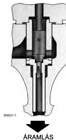
16. ábra: Fisher HPAS belső rész Micro-Flat zárótesttel
