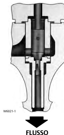
Figura 16. Trim HPAS Fisher con otturatore della valvola Micro-Flat
