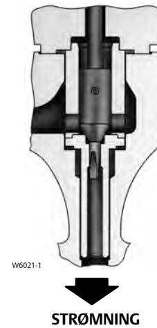
Figur 16. Fisher HPAS-trim med Micro-Flat-ventilplugg
