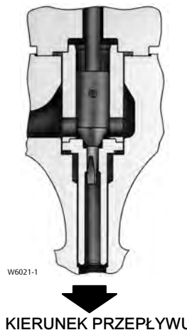
Ilustracja 17. Zespół gniazdo-zawieradło w zaworze Fisher HPT z tuleją Whisper Trim III wersja A1 (dostępna w zaworach HPD [NPS 2 - 6] i model HPS [NPS 2 i 3])
