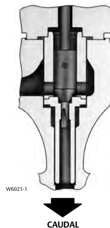
Figura 16. Interno HPAS da Fisher com Obturador de Válvula Micro-Flat
