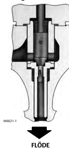
Figur 16. Fisher HPAS-trim med Micro-Flat-ventilkägla
