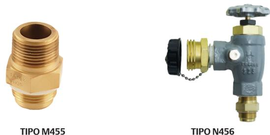
**Tipo M455:** entrada especial MNPT de 3/4 pulg. x 3/4 pulg. de salida MNPT. Abre la válvula de extracción de líquido del tanque a la distancia correcta para permitir las operaciones de transferencia. Se suministra una junta de nylon (PA) para un sellado hermético con la válvula de extracción.
