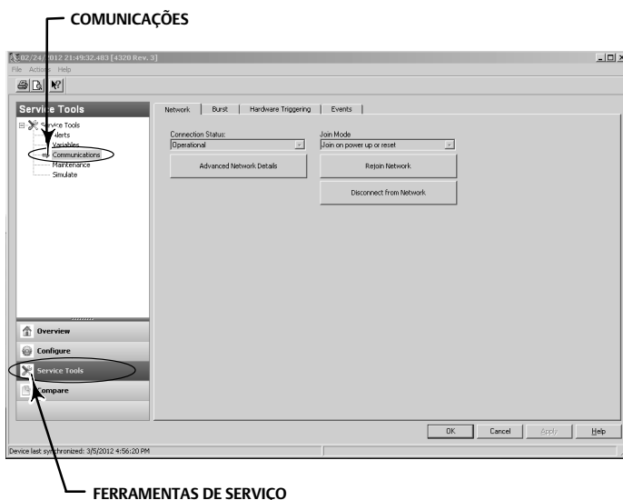
Figura 30. Como acessar o diagnóstico de comunicações no AMS Wireless Configurator e no AMS Device Manager
