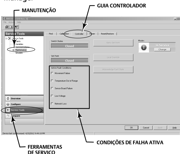
Figura 32. Visualização das condições de falha ativa no AMS Wireless Configurator e no AMS Device Manager
