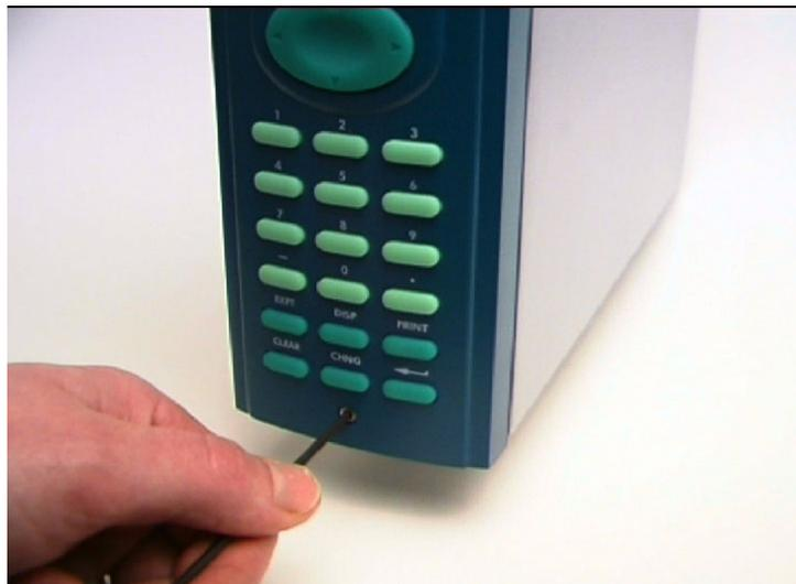
*Figure 2-2. Dépose du panneau frontal*
