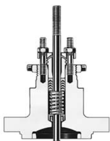
W6733 Стандартная крышка с одинарным уплотнением из колец ПТФЭ
