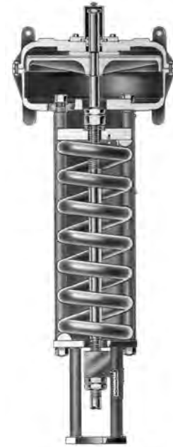
图 1. Fisher 657 型尺寸 100 执行机构剖视图
