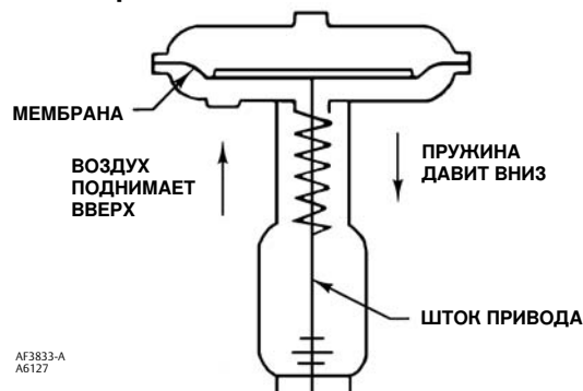
МЕМБРАНЫЙ ПРИВОД МОДЕЛИ 667 ОБРАТНОГО ДЕЙСТВИЯ
