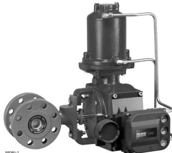
Abbildung 1. Fisher Antrieb 1061 mit Ventil V500 und digitalem FIELDVUE™ Stellungsregler DVC6200
