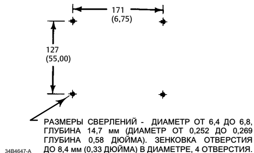
СХЕМА СВЕРЛЕНИЙ И ВНУТРЕННЕЙ РЕЗЬБЫ НА ПЛИТЕ ДЛЯ ПРИВОДОВ РАЗМЕРОВ 80 И 100
