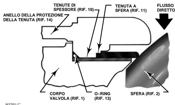
Figura 5. Dettaglio dell'anello di flusso
