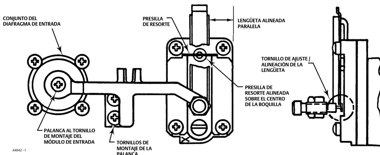
7. Volver a montar el conjunto de la palanca (clave 17) con los dos tornillos de cabeza chata (clave 7). No apretar los tornillos hasta que el tornillo de ajuste (clave 18) a la lengüeta (clave 9) y el orificio roscado ubicado en el conjunto del diafragma (clave 28) estén alineados (consultar la figura 24). Luego, apretar el conjunto de la palanca e instalar el tornillo en el conjunto del diafragma.
