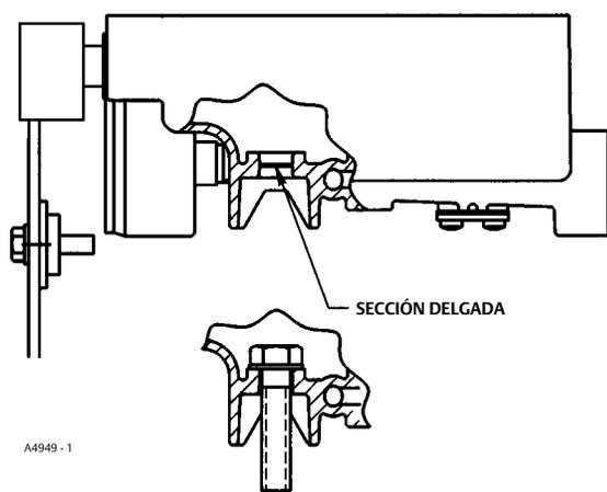
Figura 6. Instalación de la placa de realimentación para actuadores Baumann
