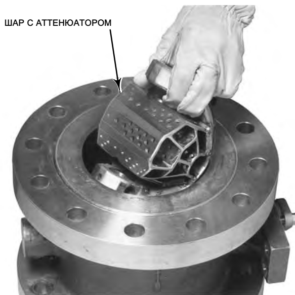
Рис. 18. Способ установки и снятия шара с аттенюатором
