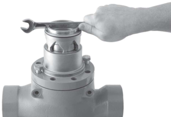
Рисунок 5. Демонтаж/установка седлового кольца или клетки с использованием корпуса клапана в качестве крепежного элемента
