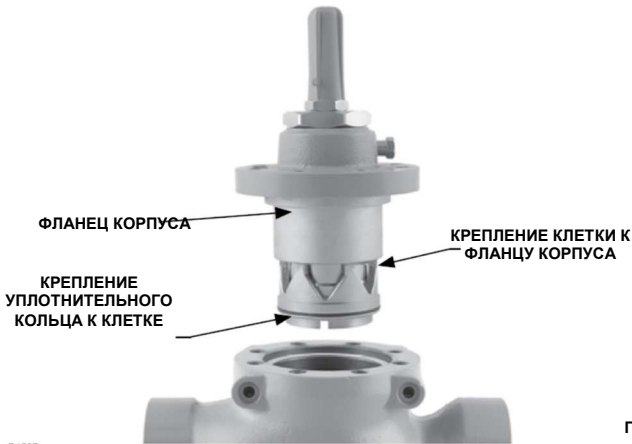
Рисунок 3. Демонтаж узла трима
