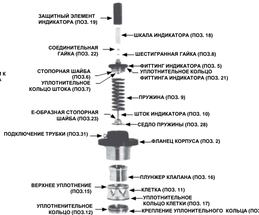
Рисунок 4. Вид узла трима в разрезе
