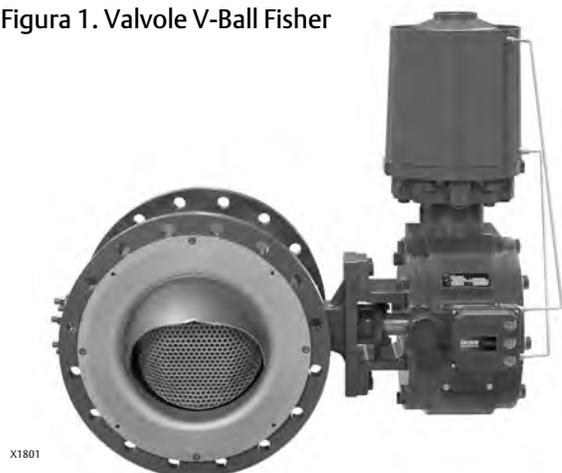
NPS 16 V150 con assetto anticavitazione Cavitrol™ Hex opzionale e attuatore Fisher 1061 con DVC6200
