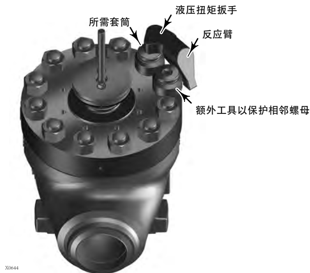
图 2. 防止阀盖螺母在装配过程中损坏的程序示意图
