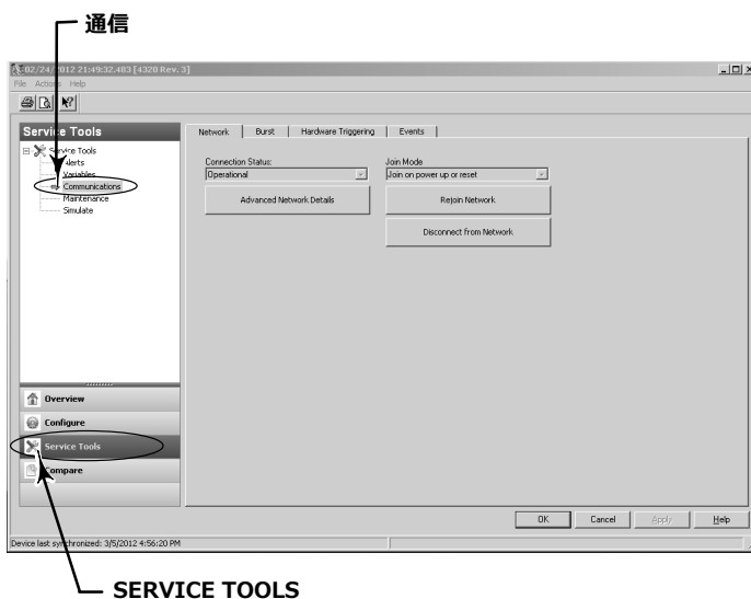
図 30 AMS ワイヤレスコンフィギュレータおよび AMS デバイスマネージャで通信診断にアクセスする
