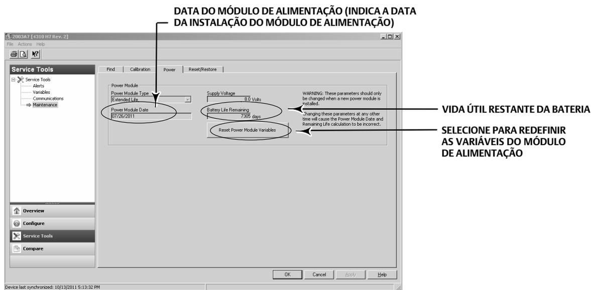
1. Uma advertência será exibida, observando que isto só deve ser feito quando um novo módulo de alimentação for instalado. Selecione *Next* se tiver substituído o módulo de alimentação. Selecione *Cancel* (Cancelar) se o módulo de alimentação não tiver sido substituído.
