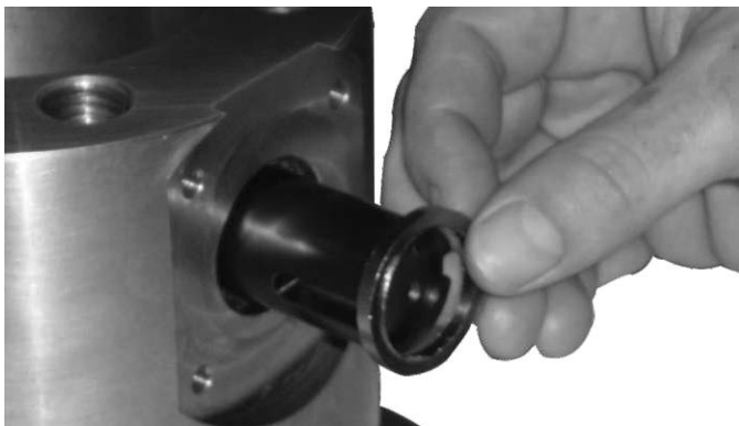
Abbildung 5. Oberen Endring einlegen
