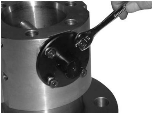
Abbildung 7. Den Packungsflansch anschrauben.
