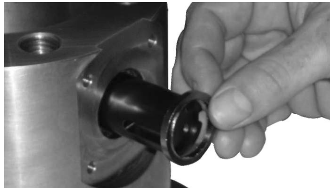
Figura 5. Insertar el anillo de extremo superior
