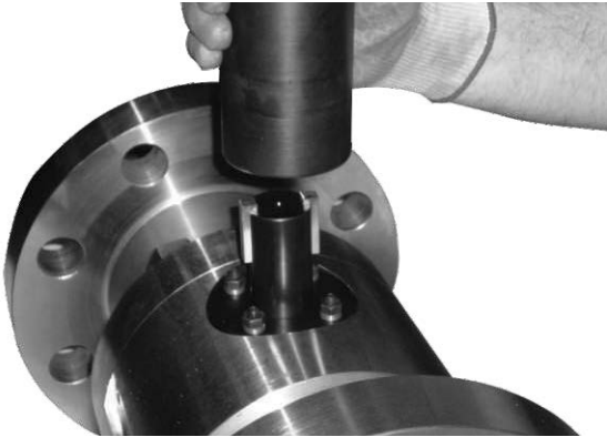
Figura 8. Montar el adaptador del eje
