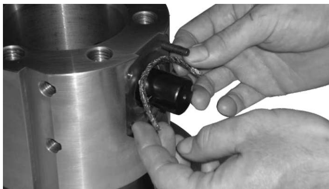
Рис. 6. Используйте уплотнительный фланец
