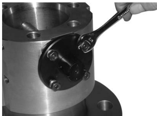
Рис. 7. Прикрутите болтами уплотнительный фланец
