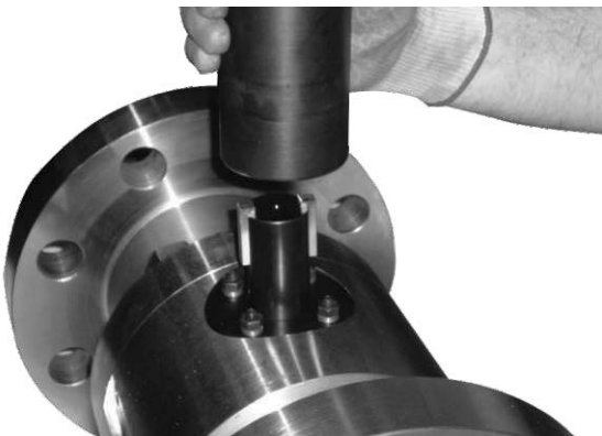
Рис. 8. Установите переходник вала
