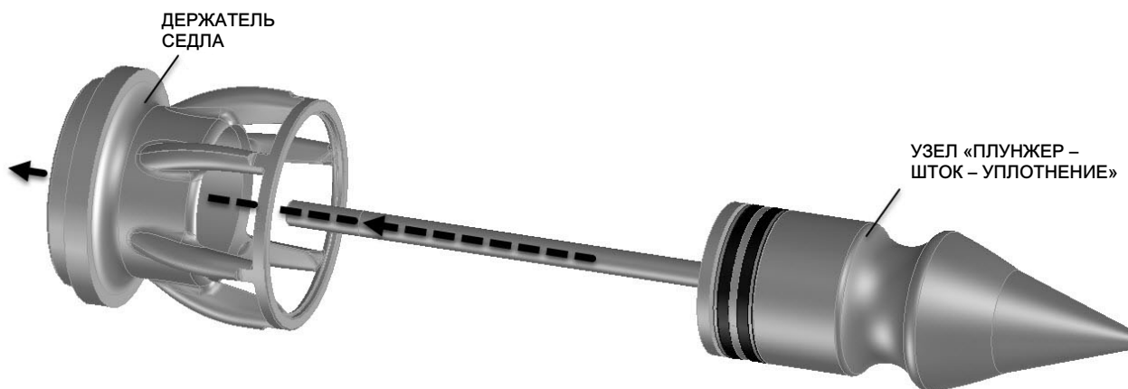
Рисунок 9. Узел клапана ССV с NPS 4 — Установка узла «плунжер – шток – уплотнение» через нижнюю часть держателя седла
