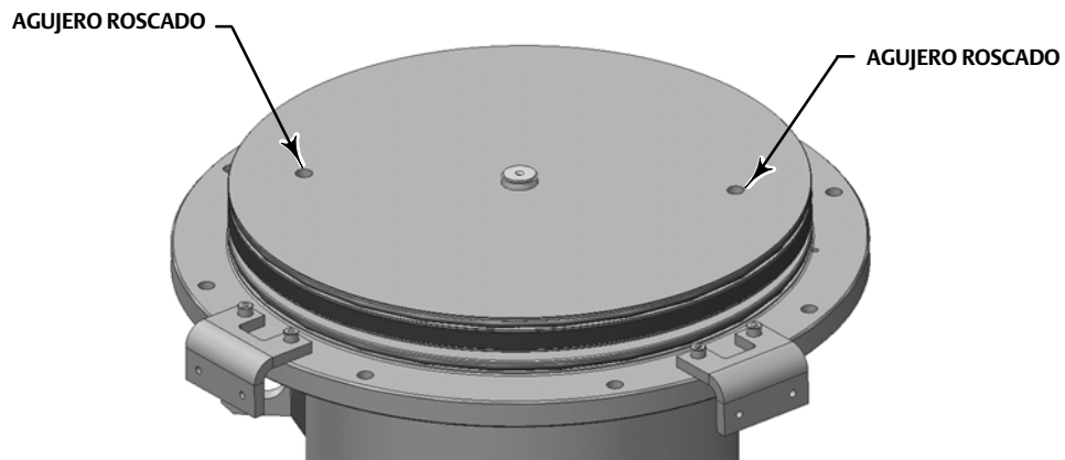
Figura 21. Agujeros roscados en el cilindro neumático
