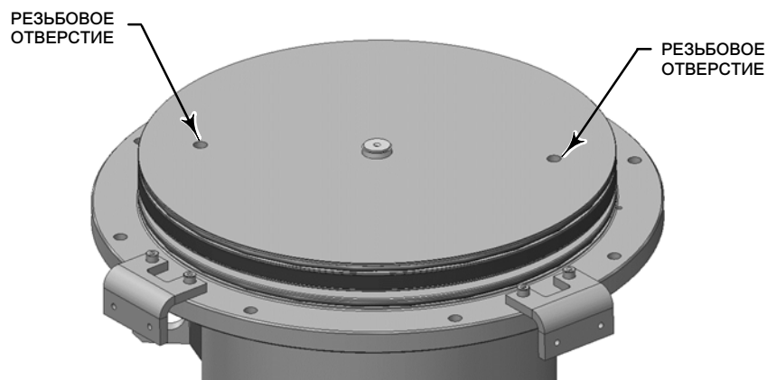
Рис. 21. Резьбовые отверстия в пневматическом цилиндре
