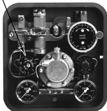
ТИПИЧНЫЙ КОНТРОЛЛЕР 2502 С ПРАВОВОСТОРОННИМ МОНТАЖОМ
