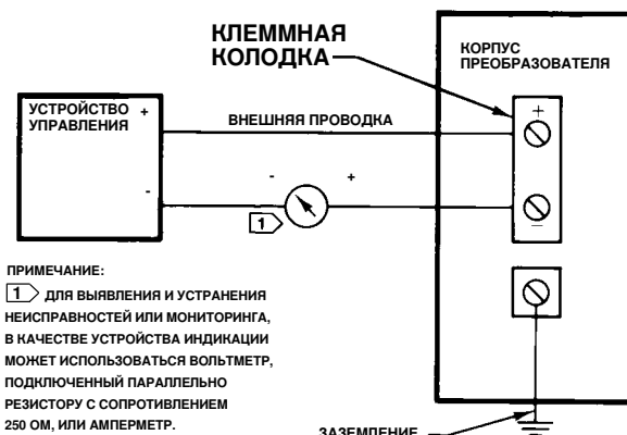
Рис. 13. Типовая схема внешней проводки
