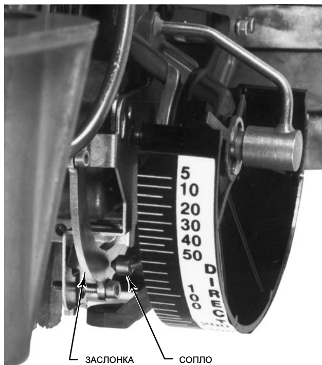
Рис. 5-5. Расположение сопла относительно заслонки
