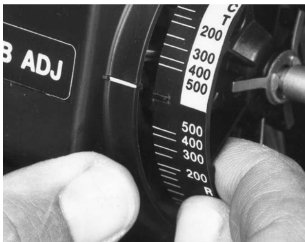
Рис. 3-2. Изменение действия контроллера (контроллеры 4194А компании Fisher)
