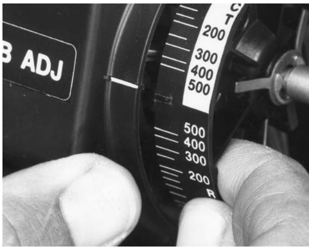
Рис. 4-3. Изменение действия контроллера (контроллеры 4194В и С компании Fisher)
