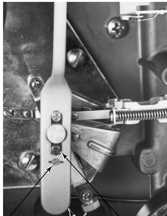
TORNILLO DE FIJACIÓN DE AJUSTE DE CERO
