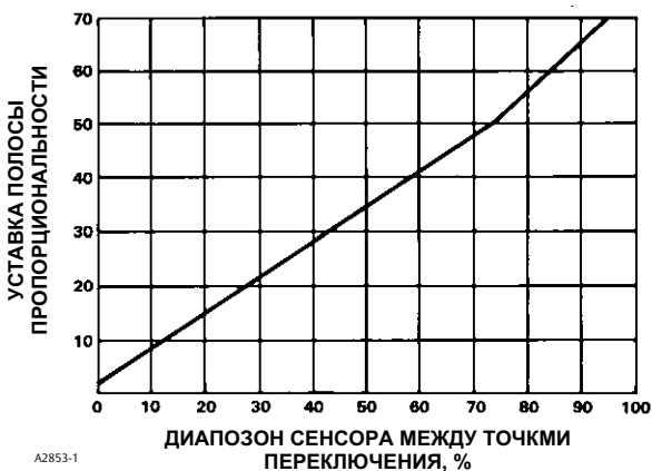
Рис. 26. Кривая для определения значения полосы пропорциональности
