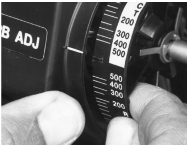
Рис. 24. Действие по смене контроллера (контроллеры Fisher 4196S)
