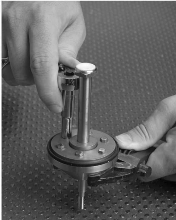
Abbildung 5. – Das mitgelieferte Werkzeug oder den Scheibensitz (Pos. 14) und die Spindel dazu verwenden, um den Schieberhalter (Pos. 8) auszurichten.
