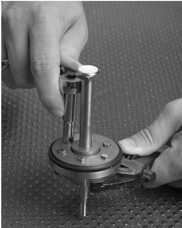
Figura 5. - Usar la herramienta incluida o el asiento del resorte (clave 4) y el conjunto del vástago (clave 2) para alinear el retén del disco (clave 8)
