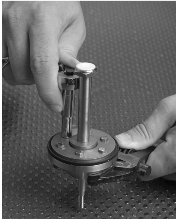
Figure 5. - Utiliser l'outil fourni ou l'ensemble siège de ressort (n° 4) et tige (n° 2) pour aligner la bague de maintien (n° 8)
