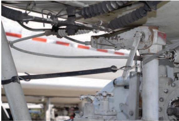
THE CABLE SHOULD BE AT A RIGHT ANGLE TO THE OPERATING LEVER AT THE MID-TRAVEL POSITION.
